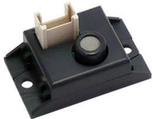
가연성 가스센서 module CGM6812-B00는 당사의 접촉연소식 센서 TGS6812를 탑재한 저렴한 장치 삽입용 센서 module입니다. TGS6812는 신뢰성이 상당히 뛰어난 센서로 Unit 제품으로서 방습성과 절연성이 요구되는 환경에 있어서도 사용 가능하도록 설계 되어 있습니다. 취급도 매우 간단하여 전원을 입력(DC5V)하는 것만으로 주변 분위기중의 가스 농도에 따른 아날로그 전압출력을 구할 수 있습니다. 전형적으로는 아래의 그림과 같은 감도 특성을 나타냅니다.
